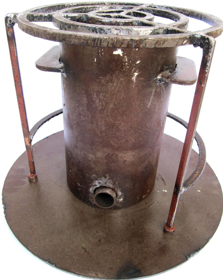
Protótipo do fogão Bio\_plan em ferro que permite dois níveis de carregamento de serradura.
